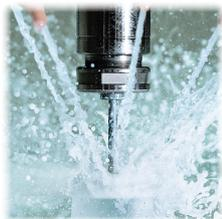
精密機械加工設備を駆使し、石英ガラスや結晶シリコン素材を様々な形状に加工していきます。主に半導体製造の前工程となるエッチング用の絶縁部材やマイクロ波透過窓等に使用されています。
