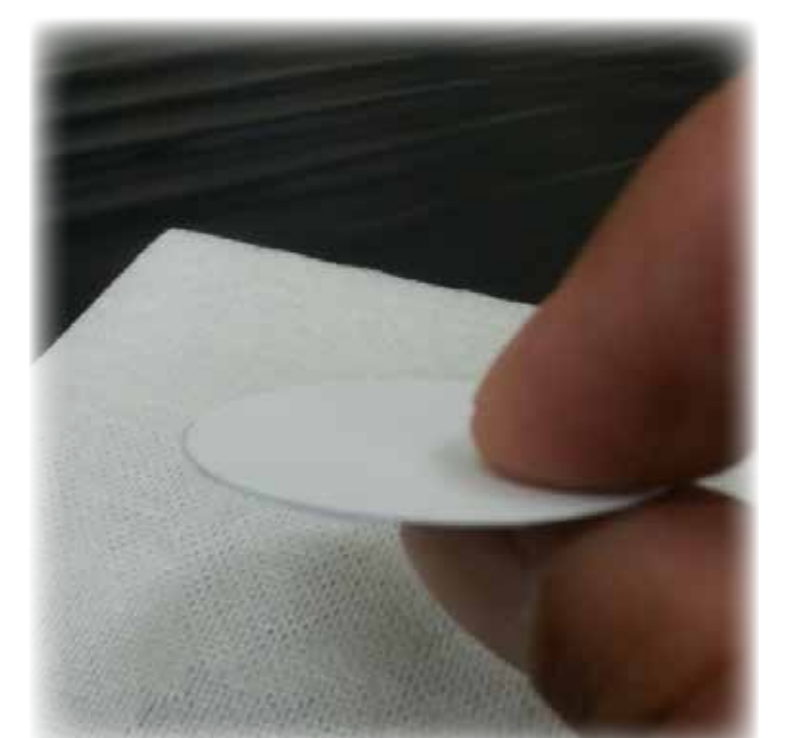
ハイブリッド材 (シリコン/イットリア) Multi-layer of Silicon on Yttria
