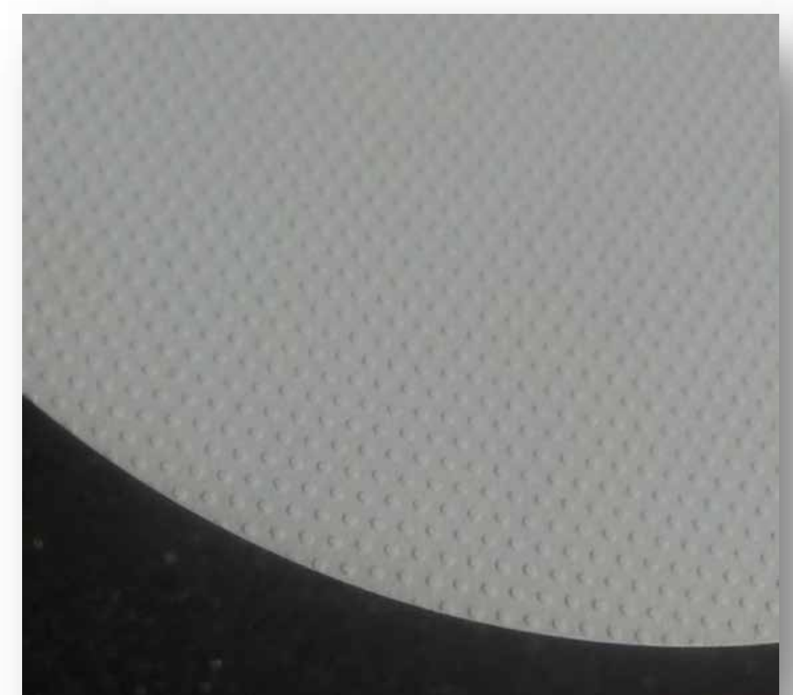
アルミナ表面にエンボスパターン形成 Embossed sheet made of Alumina
