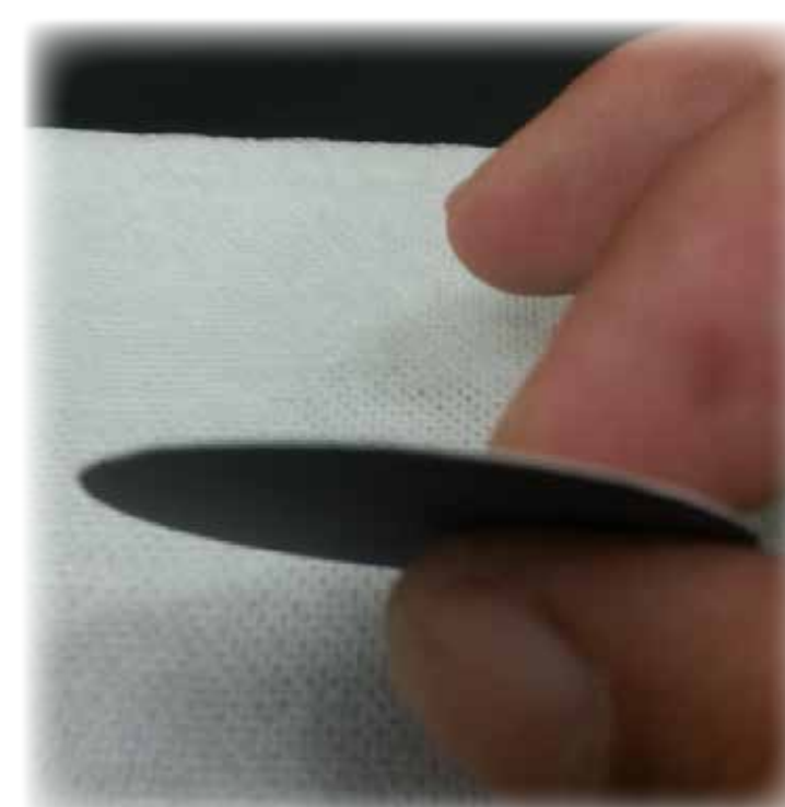
ハイブリッド材 (シリコン/イットリア) Multi-layer of Silicon on Yttria
