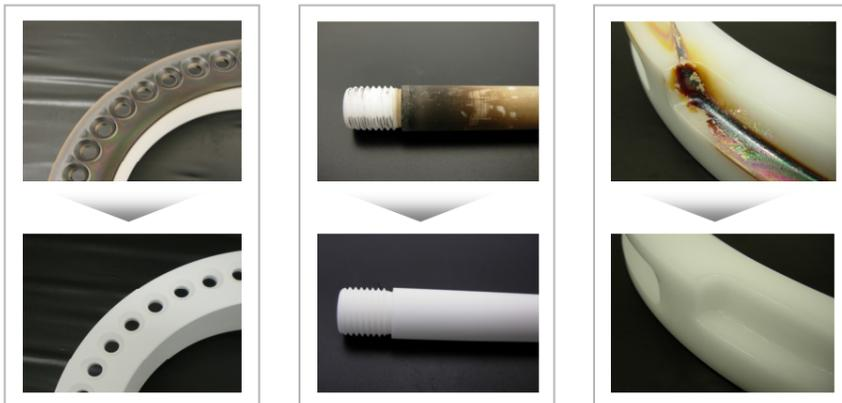
各ステップを効率良く組合せることで、マイクロクラックや微細ポアに入り込んだ強固な付着物を除去します。パーティクル低減効果の高い洗浄方法です。
