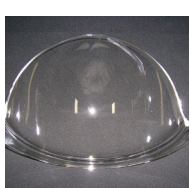
石英パーツの内面失透除去サンプル
