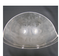
石英パーツの内面失透除去サンプル
